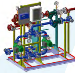
Модуль отопления Независимая схема с одним ТО и двумя насосами циркуляции отопления
