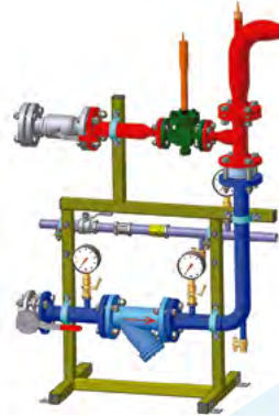
Модуль ГВС для открытой системы теплоснабжения с регулирующим клапаном прямого действия и линейной циркуляцией ГВС
