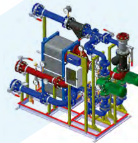
Модуль отопления Независимая схема с одним ТО и двумя насосами циркуляции отопления (для нагрузок свыше 0,5 Гкал/ч)
